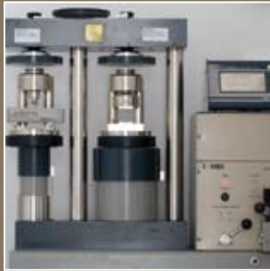
Prova di resistenza meccanica a compressione e flessione | Mechanical resistance testing machine for compression and flexure tests Essais de résistance mécanique à la compression et flexion | Mechanische Prüfungen der Druck- und Biegefestigkeit
