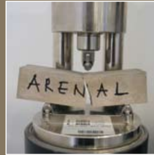
Prova di resistenza meccanica a compressione e flessione | Mechanical resistance testing machine for compression and flexure tests Essais de résistance mécanique à la compression et flexion | Mechanische Prüfungen der Druck- und Biegefestigkeit
