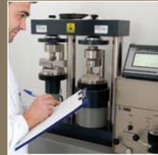
Prova di resistenza meccanica a compressione e flessione | Mechanical resistance testing machine for compression and flexure tests Essais de résistance mécanique à la compression et flexion | Mechanische Prüfungen der Druck- und Biegefestigkeit
