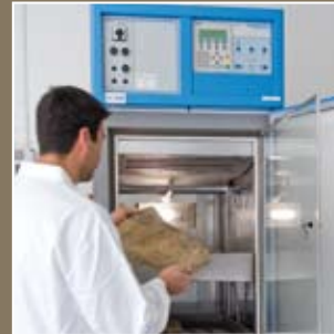
Camera climatica per le prove gelo/disgelo | Climatic test chamber for freeze/thaw tests Chambre climatique pour les essais gel/dégel | Klimakammer für die Frost-Tau-Wechsel-Prüfungen
