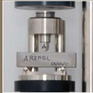
Prova di resistenza meccanica a compressione e flessione | Mechanical resistance testing machine for compression and flexure tests Essais de résistance mécanique à la compression et flexion | Mechanische Prüfungen der Druck- und Biegefestigkeit
