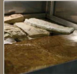
Camera climatica per le prove gelo/disgelo | Climatic test chamber for freeze/thaw tests Chambre climatique pour les essais gel/dégel | Klimakammer für die Frost-Tau-Wechsel-Prüfungen
