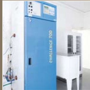
Camera climatica per le prove gelo/disgelo | Climatic test chamber for freeze/thaw tests Chambre climatique pour les essais gel/dégel | Klimakammer für die Frost-Tau-Wechsel-Prüfungen
